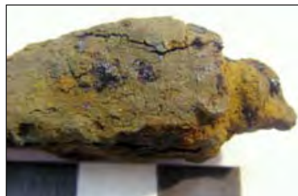
Imagen 6. Presencia de productos inestables en una pieza de hierro apreciable en las manchas cristalinas a consecuencia de la precipitación de cloruro férrico. Fuente: fondos del MUPAC.
