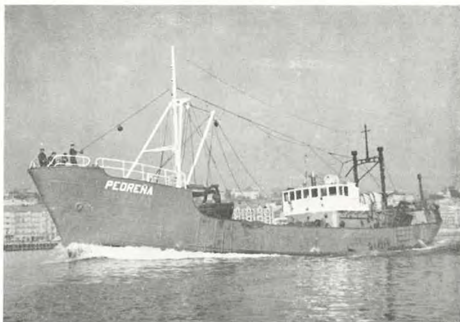
El bou PEDREÑA, de 255 tons. de registro, construído en Bilbao en 1955 (Foto Sr. Blázquez)
