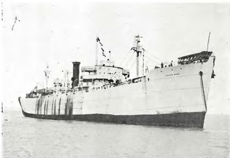
El Río Pas antes de su reconstrucción, tal y como fue adquirido con el nombre de EMPIRE MORN. Obsérvese la catapulta para un avión, en el castillo
