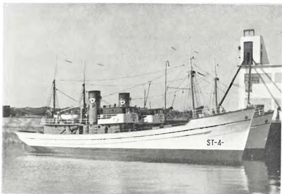
La pareja de pesca de altura CHOLÍN Y CHOLITA, de Vega Gorostegui, que se construyó en Vigo en 1948. Tenían casco de madera y 210 tons. de registro
