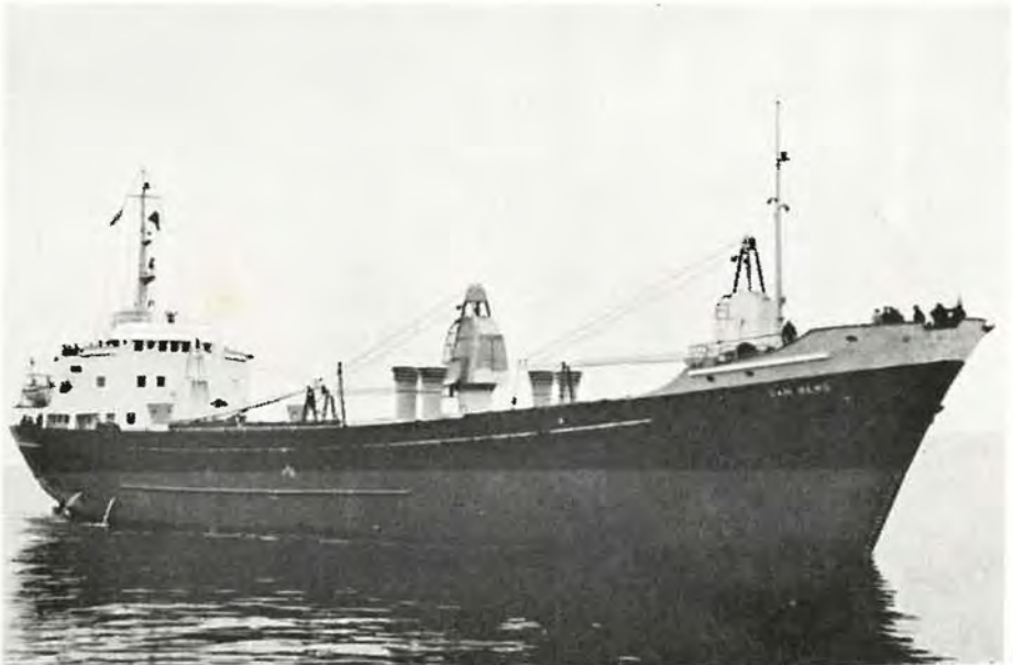
El mercante SAN REMO, de Pombo, construido en Santander en 1967. Tiene 1.600 toneladas R. B. y está equipado con grúas propias para la manipulación de la carga
