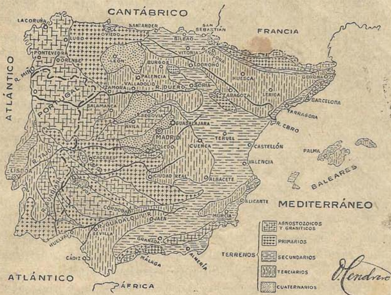
Fig. 439.—Esquema de la distribución en la Península Ibérica de los terrenos geológicos de las distintas Eras.
