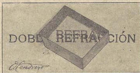
Fig. 94.—Doble refracción del espato de Islandia. (Fot. O. Cendrero).
