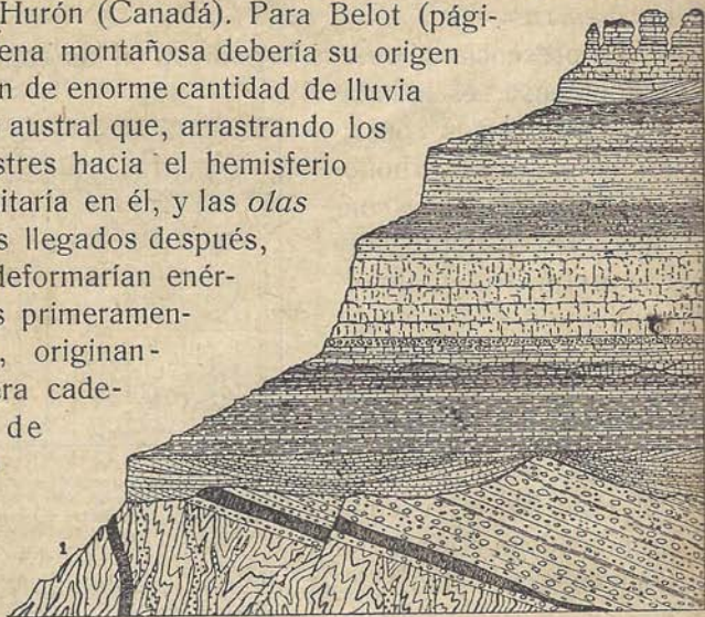
Fig. 383.—Corte de los terrenos del Gran Cañón del Colorado (Estados Unidos). 1. gneis Arcaicos; 2. arenas y conglomerados Algonkienses; 3. Cámbrico en discordancia angular con el Arcaico y Algonkiense; 4, 5 y 6 a, discordancia horizontal entre el Cámbrico (4), el Devónico (5) y el Carbonífero (6 a). (Según Fr. Frech.)—(De Haug).
