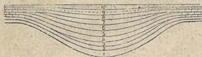
Fig. 293.—Esquema de un geosinclinal: los números 1 a 10 demuestran la continuidad de la sedimentación en el centro y la discontinuidad en los bordes. (De Haug).
