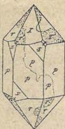
Fig. 74. Dos maclas de intrusión del cuarzo. (Tschermak, Sansoni).
