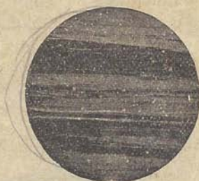
Fig. 331. — Estructura vítrea de una obsidiana, vista al microscopio con poco aumento.
