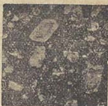
Fig. 328.—Estructura semicristalina de un pórfido, a simple vista.
