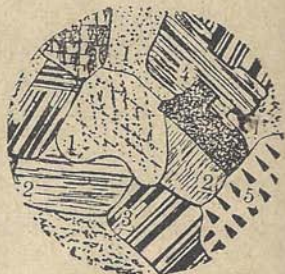
Fig. 327.—Granito visto al microscopio a luz polarizada.—1, cuarzo; 2, ortosa; 3, plagioclasa; 4, mica, 5.
