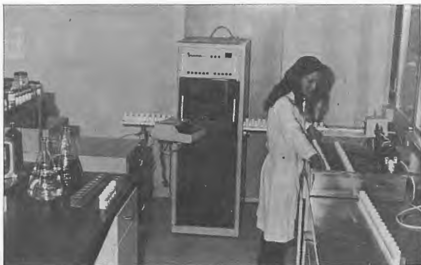
Realización del recuento celular para detección de mamitis, por medio de un aparato Fossomatic, en los laboratorios del Centro de Investigación y Desarrollo de la Lactaria Española en Renedo (Cantabria).
